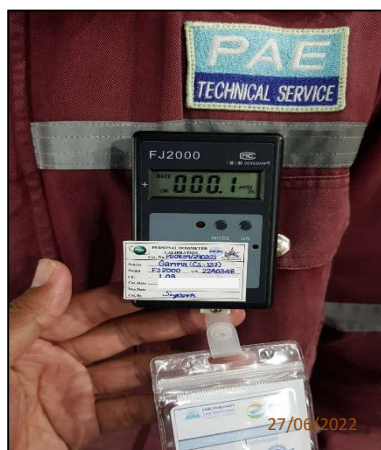
รูปที่ 2-23 งานเชื่อมต่อท่อ ตรวจสอบรอยเชื่อม และผู้ปฏิบัติงานตรวจสอบ กันบริเวณพื้นที่และติดอุปกรณ์วัดรังสี ขณะปฏิบัติงาน
